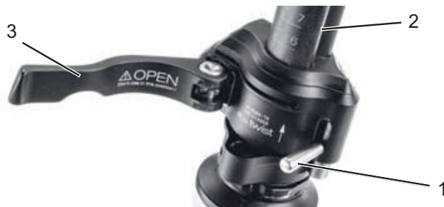
Afbeelding 23: Geopende spanhendel van de snelspanner (3) op de voorbouw (2), uitvoering I, met vergrendelhendel (1) op de voorbouw
