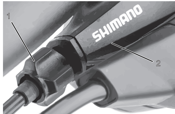
Afbeelding 34: Afstelwartel (1) van de versnelling met enkele bowdenkabelbediening en behuizing van de schakelhendel (2), voorbeeld
