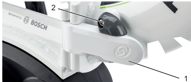
Afbeelding 26: Frame, met gesloten spanhendel (1) en gesloten vergrendelhendel (2)
