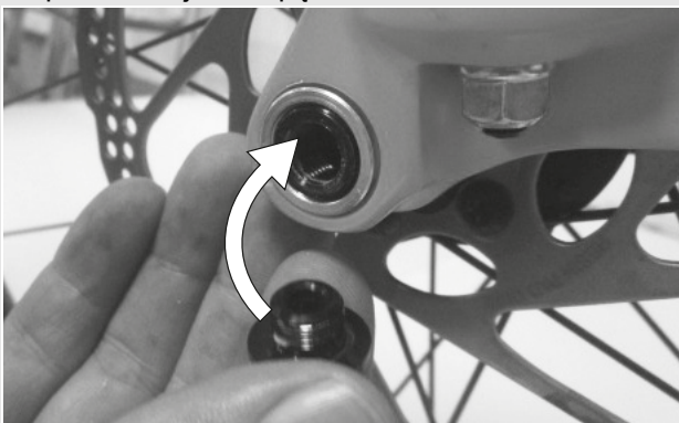
Rysunek 15: Sposób wsuwania dźwigni zacisku szybko mocującego w oś
