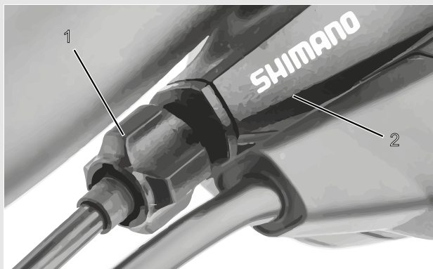
Rysunek 68: Nakrętka regulacyjna (1) jednoczęściowego mechanizmu zmiany przerzutek z obudową dźwigni zmiany biegów (2), przykład
