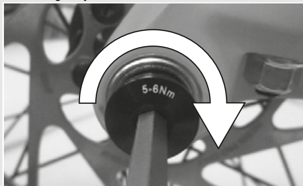
Rysunek 16: Sposób dokręcania śruby zabezpieczającej
