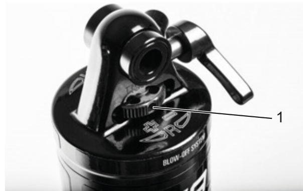
Rysunek 49: Nastawnik odbicia koła Suntour (1) na tylnym amortyzatorze
