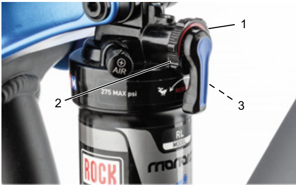
Rysunek 61: Ustawianie twardości tłumika odbicia za pomocą pokrętła regulacyjnego (1)
