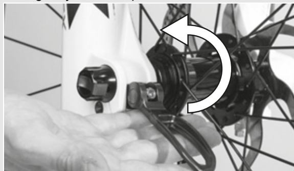
Rysunek 22: Sposób zabezpieczania dźwigni
