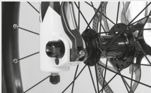
Rysunek 66: Ustawianie siły mocowania zacisku szybkomocującego
